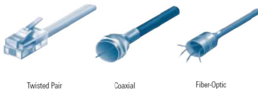
شکل 2 انواع کابل مورد استفاده در شبکه
